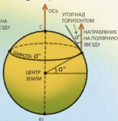
Рис. 5. Равенство отмеченных углов вытекает из того, что касательная к окружности перпендикулярна радиусу, проведённому к точке касания
