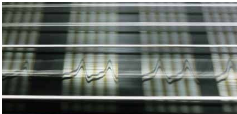
Фото 4. Струны расположены горизонтально, колеблется вторая снизу струна. Фотоаппарат во время съёмки двигался справа налево. Порожки, двигаясь в кадре слева направо, получились светлыми полосатыми прямоугольниками.
