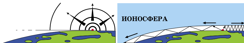
Рис. 5. Слева – распространение со временем единичного сигнала видимого света, а справа – радиосигнала, отражаемого ионосферой
