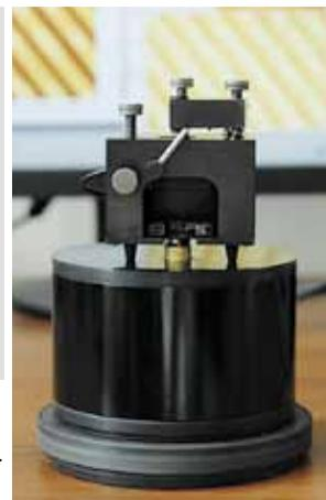
па – это сканирующий зонд, или, попросту говоря, очень острая игла. При контакте зонда и образца на зонд действует сила. Из-за неровностей на поверхности образца эта сила будет меняться при движении зонда.
