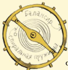
Рис.2. Балансир со спиральной пружиной работает как маятник – балансир делает колебания анкера не слишком быстрыми и довольно равномерными, экономно расходуя энергию спускового колеса, а пружина ещё улучшает эти свойства
