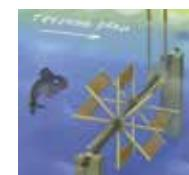
Лопасти будут вращаться по часовой стрелке, поскольку у поверхности реки течение более быстрое, чем у дна, и, значит, давление на верхние лопасти будет больше, чем на нижние.
