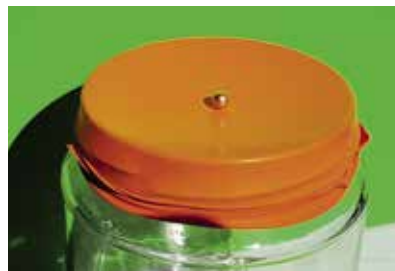
Из-за разности давлений плёнка принимает сферическую форму
