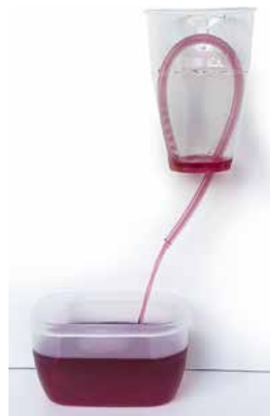
Рис. 5. Самозапускающийся сифон в момент полного опорожнения; трубка выходит через отверстие в дне стаканчика
