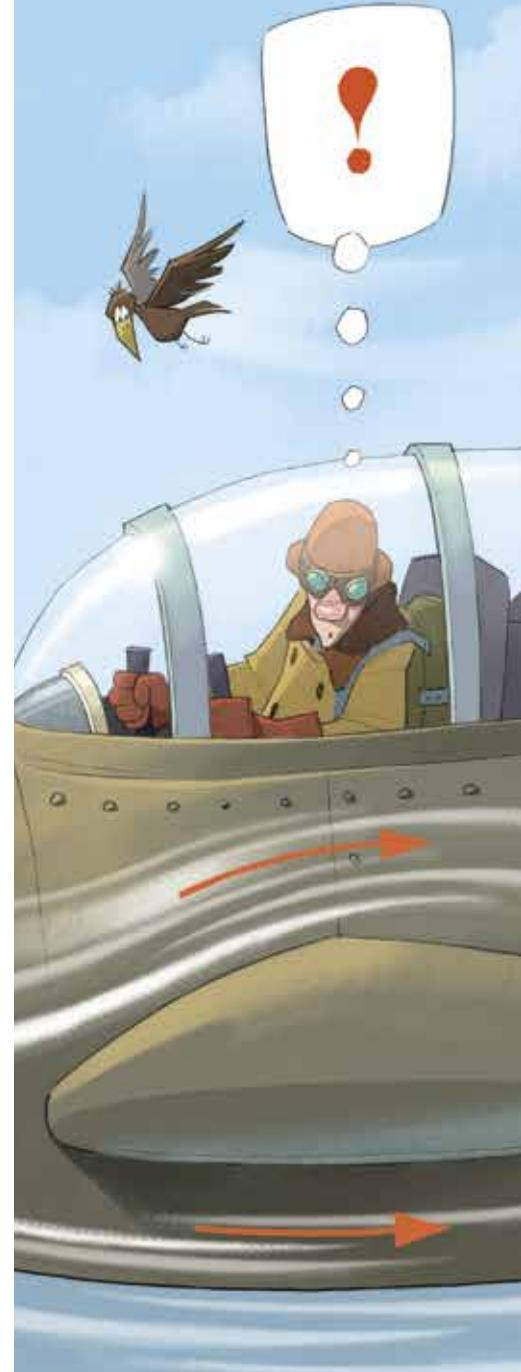
крылом меньше, чем давление под крылом. Эта разность давлений и создаёт подъёмную силу, за счёт которой летящий самолёт держится в воздухе.
