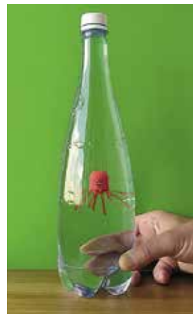
Рис. 1. Стандартный водолаз и картезианская медуза: если сжать бутылку, они опускаются, если отпустить – поднимаются; см. kvan.tk/diver и kvan.tk/jellyfish1
