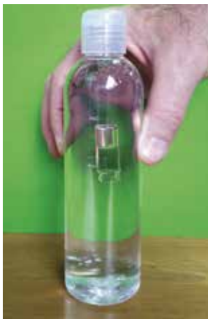
Рис. 1. Стандартный водолаз и картезианская медуза: если сжать бутылку, они опускаются, если отпустить – поднимаются; см. kvan.tk/diver и kvan.tk/jellyfish1
