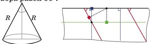
5. Ближайшая к вершине точка – та, в которой направление на вершину перпендикулярно геодезической. На развёртке тоже нужно опустить из центра конуса перпендикуляр на геодезическую.
