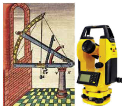
Рис. 4. Секстант Тихо Браге и современный теодолит
