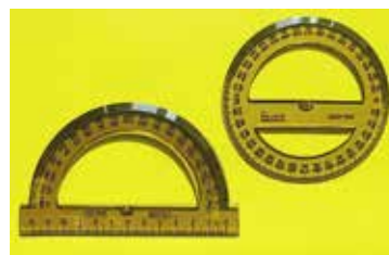
Рис. 3. Транспортиры – полукруговой и круговой
