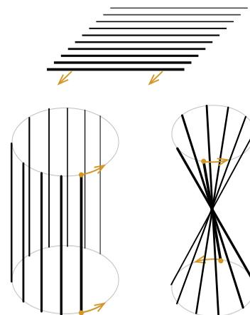
Поверхности, образованные движением прямой, называют *линейчатыми*, а саму эту прямую – *образующей*. А так ли невероятно, что линейчатую поверхность конуса и цилиндра можно свернуть из листа? Любую ли линейчатую поверхность можно получить сворачиванием листа бумаги? Оказывается – нет.
