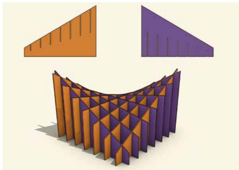
Ту же самую поверхность можно получить по-другому. Возьмём две прямые, отметим на каждой прямой одинаковое количество точек на равных расстояниях, пронумеруем их по порядку. Соединим отрезком каждую точку с точкой на другой прямой с тем же номером. Отрезки заметут поверхность. Если
