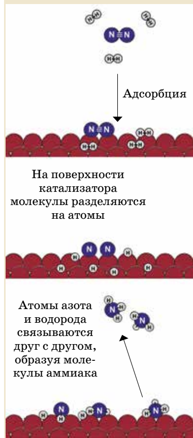
Упрощённая схема происходящего на катализаторе
