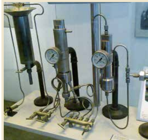
Установка Габера для синтеза аммиака
